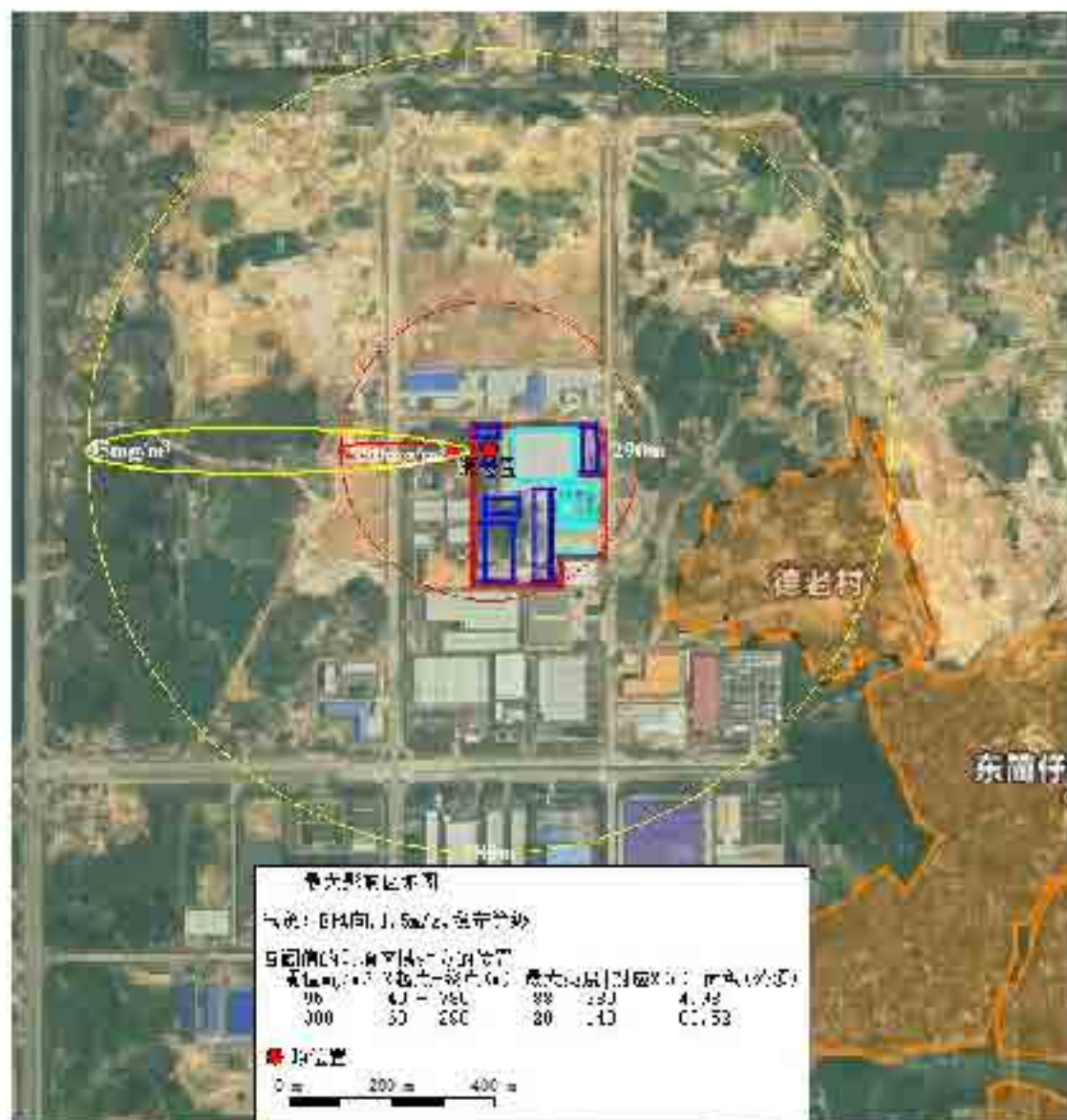
图 8.6-6 最不利气象条件下，MIBK 储罐发生火灾事故时次生 CO 排放最大影响范围图
