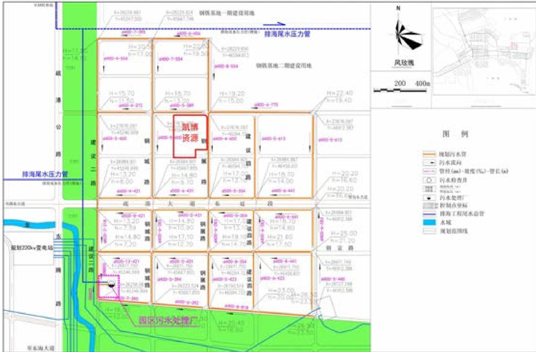
图 2.2-4 项目远期依托钢铁项目配套产业园区污水处理厂及尾水管网走向图
